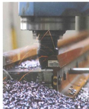
Bewerken van een spoorstaaf tot compensatielas.
